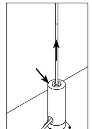
Pour ressortir le filin, appuyer sur le piston supérieur et tirer sur le filin.
