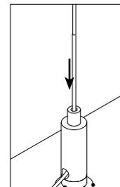
Régler la longueur des suspentes grâce au système de réglage rapide.
