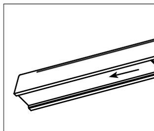
Coulisser la plaque de PMMA noir jusqu'au mur
