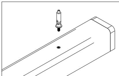
Visser la tête de réglage de câble orientable dans l'insert en bout du bras de l'applique
