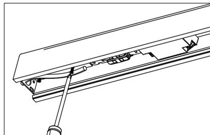
Positionner la moulure sur l'équerre et remettre les 2 vis.
