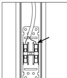
Connecter l'appareil à l'aide des 2 connecteurs rapides WAGO (Phase, Neutre)
