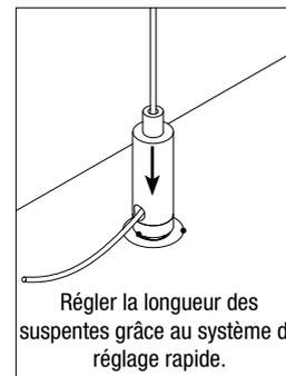
Régler la longueur des suspentes grâce au système de réglage rapide.
