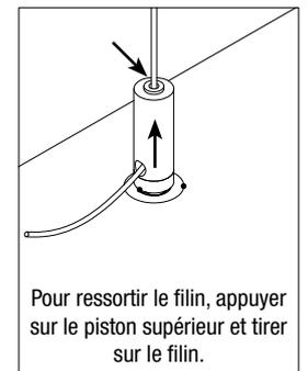
Pour ressortir le filin, appuyer sur le piston supérieur et tirer sur le filin.
